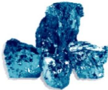
*Photo 37 : Cristaux de silicium, composant unique pour la fabrication du silicium multi-cristallin (source : Quadran)*
