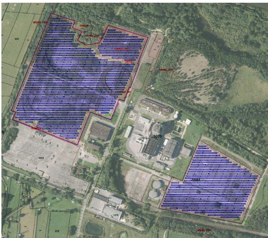
Figure 3 : Avant-projet de centrale photovoltaïque : exploitation de l'intégralité des surfaces (source : Quadran)
